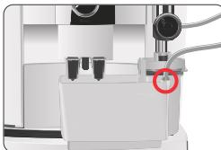
**i** Для правильного під'єднання молочного шланга до контейнера для очищення системи приготування молока необхідно, щоб молочний шланг був оснащений з'єднувальною деталлю НРЗ.
